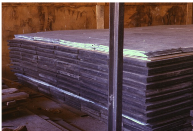
Рисунок 3: Эмульсионный эксперимент на г. Чакалтай (Анды, Боливия). Уникальные характеристики установки - высота расположения (4370 м н.у.м.); крупнейшая в мире ( \sim 1000 \text{ m}^2 ) твердотельная трековая камера с высоким пространственным разрешением ( \sim 10 \text{ мкм} ) и с высоким порогом регистрации частиц ( \sim 4 \text{ ТэВ} )
