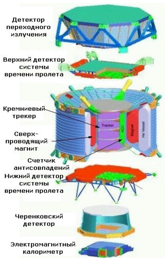
Рис.5 Покомпонентный вид AMS-02
